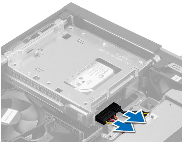
4. Сдвиньте синий фиксатор отсека дисков в положение разблокировки и извлеките отсек для дисков из компьютера.
