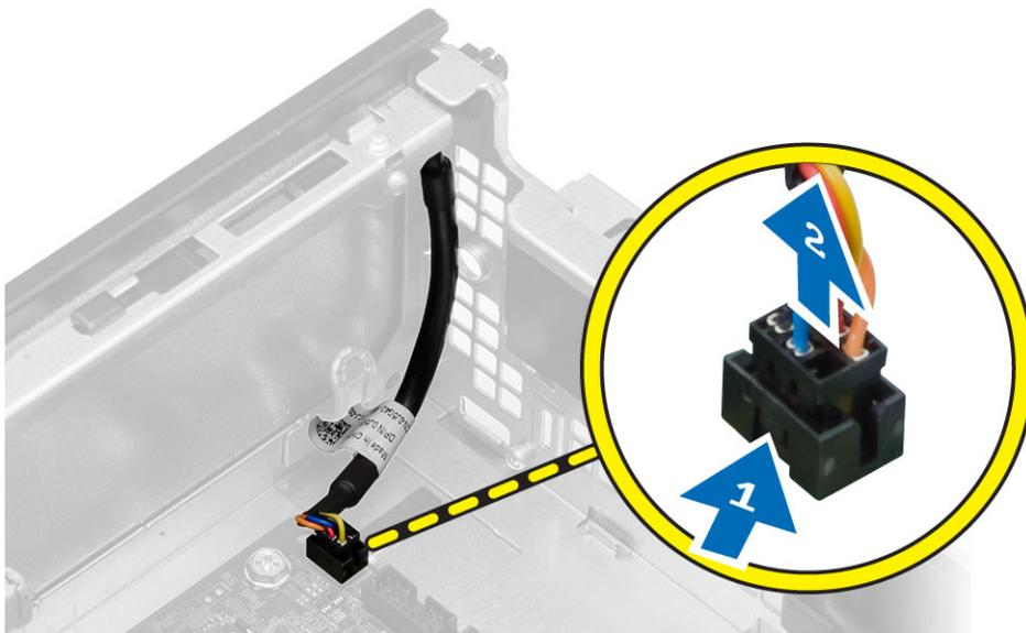
4. Нажмите на зажимы с обеих сторон переключателя питания, чтобы высвободить его из корпуса компьютера, и извлеките его вместе с кабелем.
