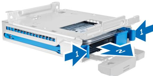
4. Отогните кронштейн жесткого диска и извлеките жесткий диск из кронштейна.
