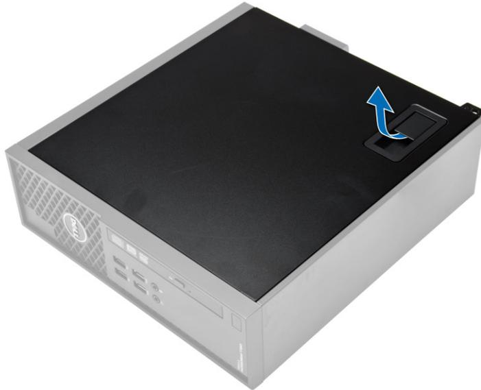
3. Поднимите крышку вверх под углом в 45 градусов и снимите ее с компьютера.
