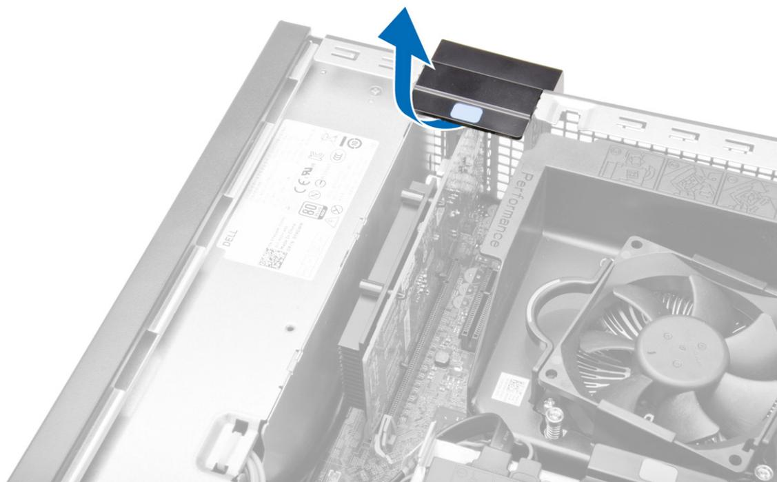
4. Отведите рычажок фиксатора от платы расширения, чтобы высвободить фиксатор из выемки в плате. Затем приподнимите плату, извлеките из разъема и выньте из компьютера.
