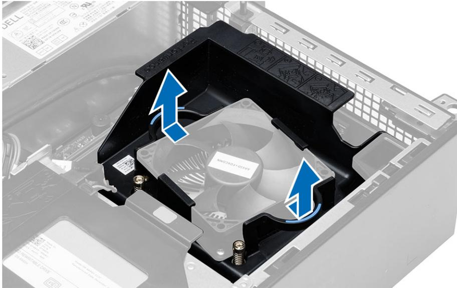
4. Отсоедините кабель вентилятора от системной платы. Ослабьте крепежные винты блока радиатора и извлеките его из компьютера.
