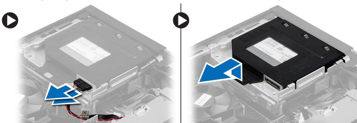
5. Отогните скобу оптического дисковода, а затем извлеките оптический дисковод из скобы.
