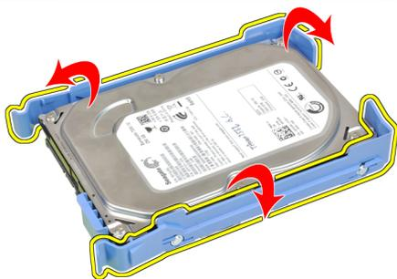
5. Выверните винты, которыми мини жесткий диск крепится к скобе жесткого диска, и извлеките жесткий диск из скобы.
